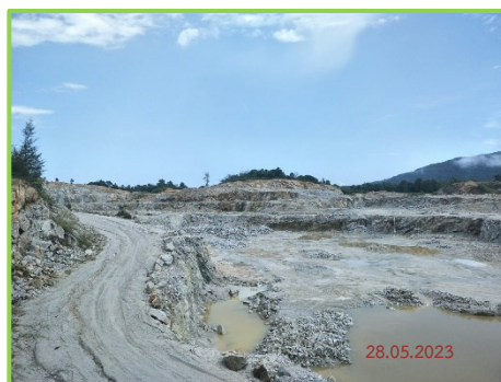
ภาพที่ 2-21 การเปิดหน้าเหมืองแบบบันได
