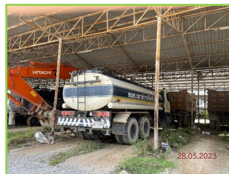
ภาพที่ 2-6 รถบรรทุกฉีดพรมเส้นทางขนส่งแร่
