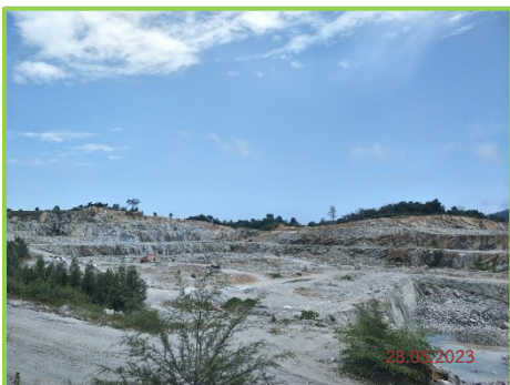
ภาพที่ 2-3 ลักษณะหน้าเหมืองแบบขั้นบันได
